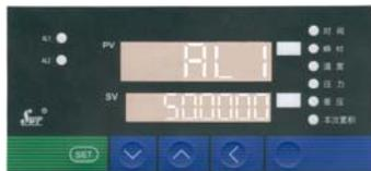
在仪表PV瞬时流量测量值，SV累积流量值显示状态下按压**SET**键，即进入参数设定状态。屏幕显示第一报警参数符号AL1及出厂预定值。在AL1设定状态下，按压左移键直至参数值5闪烁。
