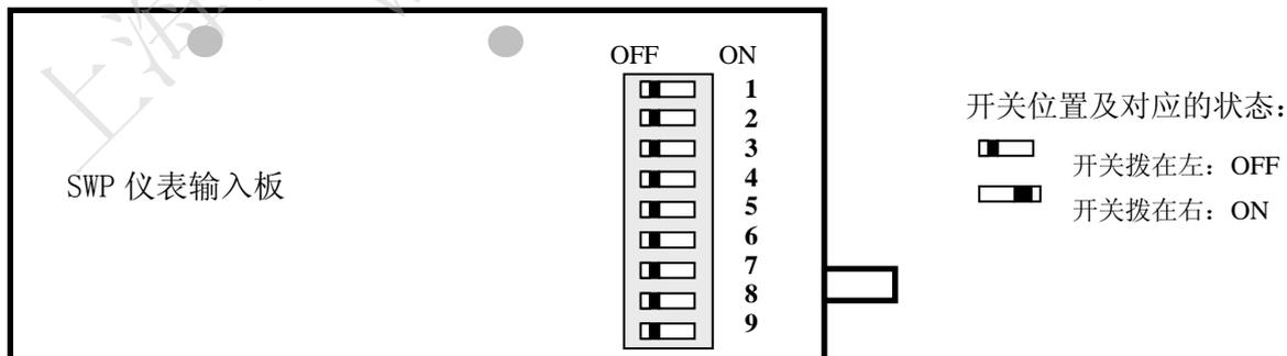
仪表输入板拨码开关位置组合与输入信号关系表:
