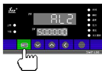
按压SET键，确认参数设定值正确并进入下一参数设定，第一报警参数设定即告完毕。
