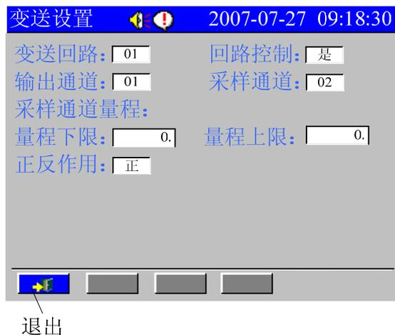
图 5.14 变送算法参数设置画面
