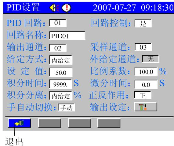
图 5.12 PID 通道参数设置画面
