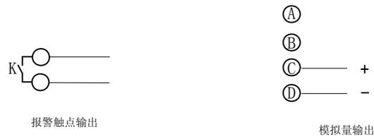
图 3.5 输出信号接线图
